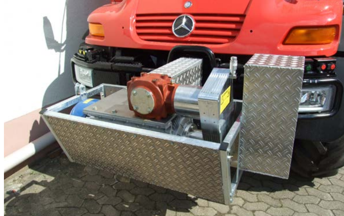
Unimog mit Unterflurgenerator
